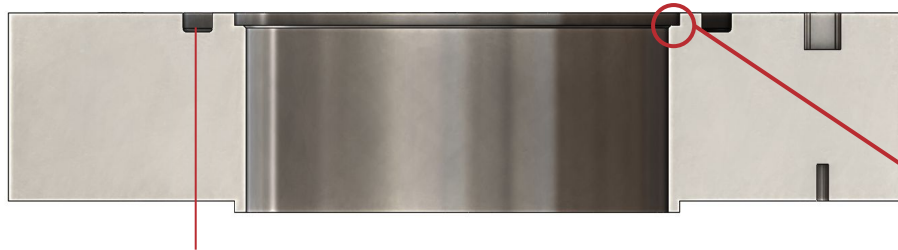
-232 Buna-N70 O-Ring Groove per Parker O-Ring Handbook
